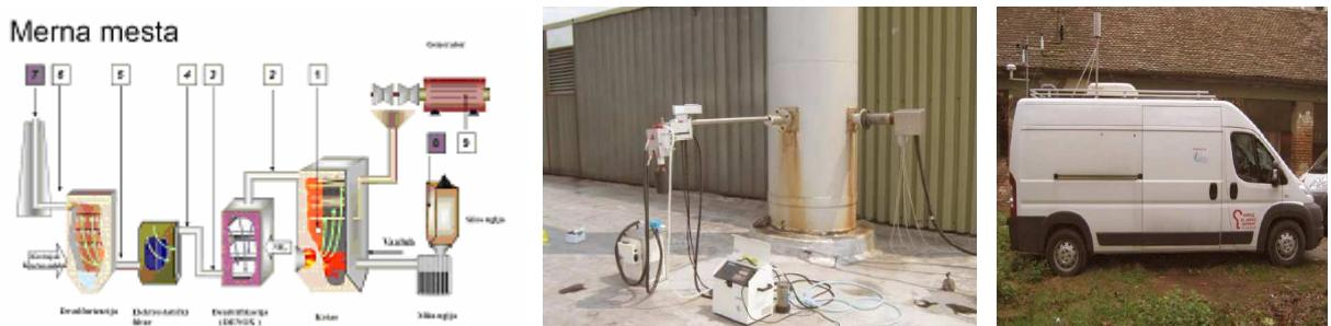
Slika 5.6 Merenje u TE, stacionarni merni aparati, i mobilna merna stanica (s leva na desno) [29].
